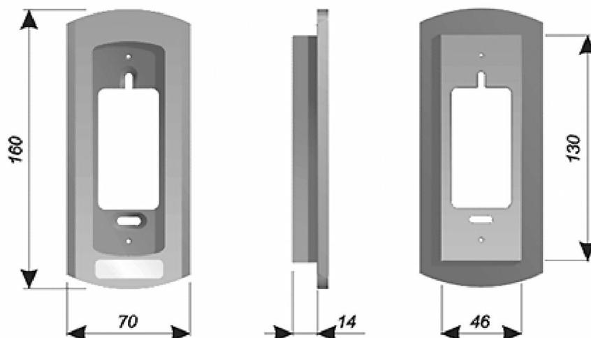
Наличие специально разработанного кронштейна для поворота панели на 30° и врезной установки делают вызывную панель аудиодомофона AVC-105 очень универсальной и позволяют установить её практически в любом месте. Кронштейн изготовлен из прочного металлического сплава, покрыт ударопрочной порошковой эмалью и очень прост в установке.
