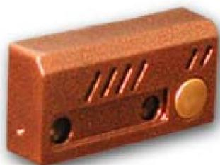
Вызывная панель крепится в непосредственной близости от входной двери и имеет микрофон, динамик, кнопку вызова. Отличительной особенностью является очень малые размеры, что позволяет использовать панель как модуль для наращивания количества абонентов ( на 2, 3, 4 квартиры), с соответствующим добавлением аудиотрубок. Питание панели осуществляется непосредственно от абонентской трубки.
